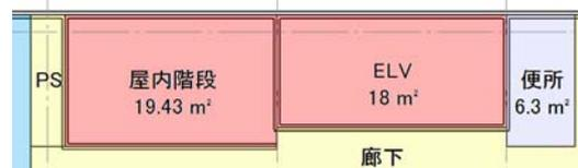
④ 《リボン》[修正] から [トリム] を選択します。屋内階段と ELV の壁をつなげます。
